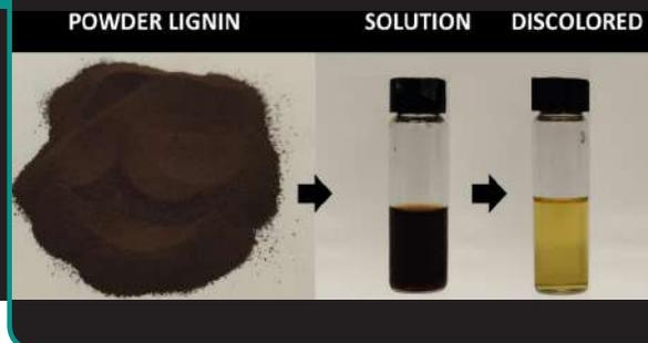
e cercando di mantenere quanto più possibile i cromofori che invece conferiscono al biomateriale un assorbimento nel range dell'ultravioletto (UV-A e/o UV-B). Tale caratteristica è in grado di conferire al prodotto proprietà utili per un impiego come agente coadiuvante (booster) di filtri per la protezione solare (SPF).
