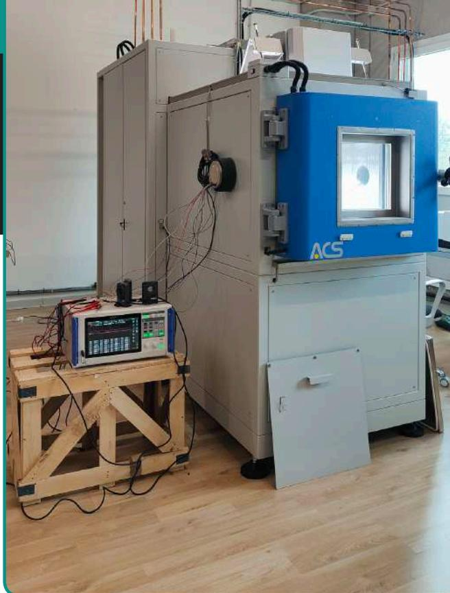
1200W). La camera consente di riprodurre sia condizioni statiche che variabili con lo scopo di riprodurre le condizioni climatiche giornaliere caratterizzanti un qualsiasi clima di interesse. Durante il test, ogni campione viene monitorato utilizzando almeno tre termocoppie e un sistema di acquisizione dedicato che raccoglie dati con un intervallo di 10 secondi.
