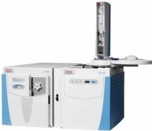
Il TSQ 9610 è un sistema GC-MS/MS (gas chromatography – tandem mass spectrometry) a triplo quadrupolo progettato per analisi chimiche altamente sensibili e selettive. Consente l'identificazione e la quantificazione precisa di composti organici volatili e semivolatili in matrici complesse, con applicazioni in chimica ambientale, alimentare, farmaceutica e industriale. Grazie alla sua affidabilità e versatilità, è uno strumento chiave per ricerca, sviluppo e controllo qualità.
