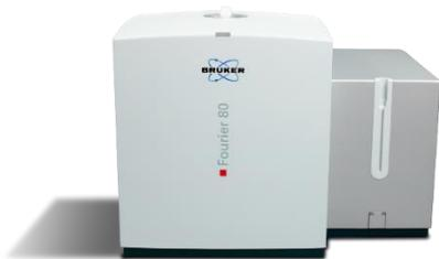
Il Benchtop NMR System di Bruker è un sistema di risonanza magnetica nucleare compatto progettato per l'analisi chimica rapida e precisa di composti organici e inorganici. Permette di ottenere informazioni sulla struttura molecolare, composizione e dinamica di soluzioni, polveri o materiali liquidi. La sua compattezza lo rende ideale per laboratori industriali e accademici, supportando ricerca, sviluppo e controllo qualità.
