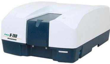
Il V-780 è uno spettrofotometro ad alta precisione che copre l'intervallo UV, Visibile e NIR (Near Infrared), progettato per analisi quantitative e qualitative di materiali in soluzione, film o campioni solidi. Garantisce misurazioni accurate e riproducibili, con possibilità di analisi cinetiche e spettro-fotometriche avanzate.
