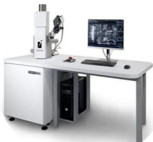
Il SEM (Scanning Electron Microscope) Tescan VEGA Compact con EDX è uno strumento versatile per l'analisi morfologica e composizionale dei materiali. Combina imaging ad alta risoluzione con analisi elementare puntuale e su aree estese. È progettato per applicazioni industriali e di ricerca.
